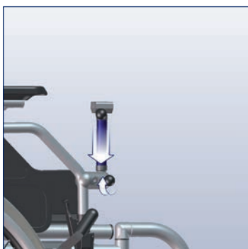
Bediengeräte-Halterung ⑤ anbringen.
