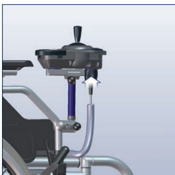
Spiralkabel ④ einstecken.
